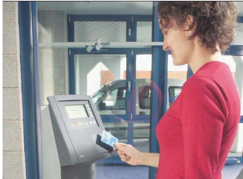
U slučaju nestanka napona napajanja, u terminal je ugrađena baterija koja će sačuvati postojeće podatke u terminalu. Čim se ponovo uspostavi napajanje, terminal će se automatski resetovati u regularan režim rada.
